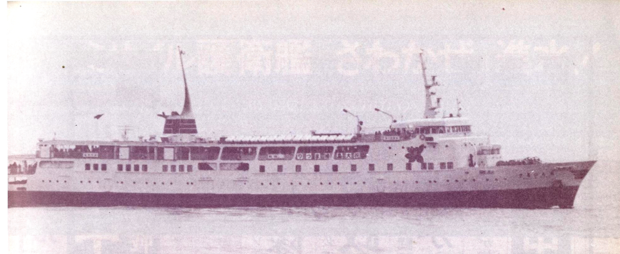
東海汽船の大島航路客船さるびあ丸。3,079総トン、航海速度17.7ノット、船客定員2,256名。1973年完成。(伊藤 紘一)
