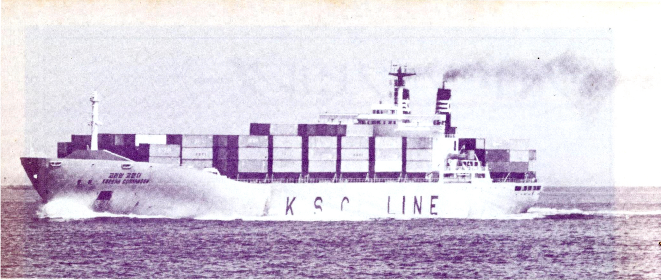
韓国海運会社のコンテナ船コーリアン・コマンドーKorean Commander。25,447重量トン、速力23.5ノット。(佐藤 善平)
