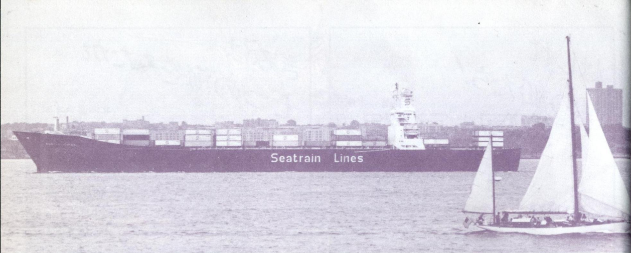
ニューヨーク港の米シートライン社ガス・タービン・コンテナ船ユーロフレイターEurofreighter。30,908総トン、1971年建造。
