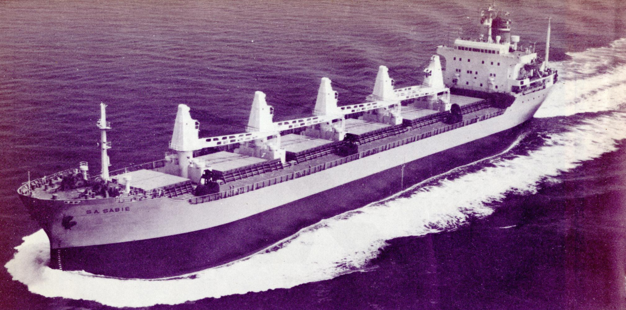
西ドイツ向け輸出搬積貨物船サビーSabie。三井造船藤永田造船所で6月30日竣工。26,713重量トン、航海速力15.5ノット。
