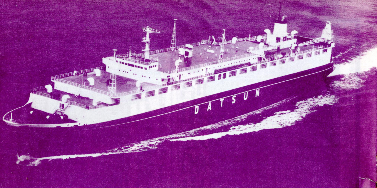
明治海運・大阪商船三井船舶共有の自動車運搬船“鶴見丸”。日立造船舞鶴工場で6月29日完成。乗用車搭載数約2,950台。
