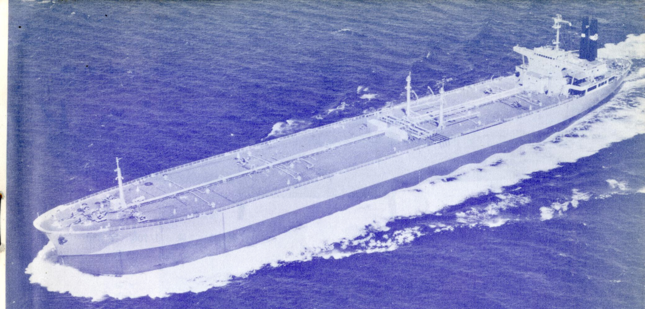
大洋商船・日本郵船共有の新造油送船美洋丸。佐世保重工佐世保造船所で5月22日完成。76,571重量トン、航海速力15.5ノット。
