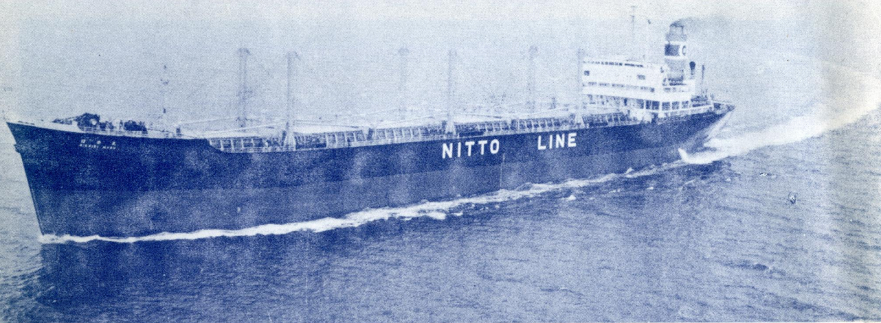
タンカーから鉱石専用船に改造された日東商船の“日栄丸”改造工事は11月15日石川島播磨重工業東京第2工場で行われたが、この結果載貨重量トン数は19,076トンから24,000トンとなり、主機に変化しないため航海速度は14ノットから13.5ノットとなった。
