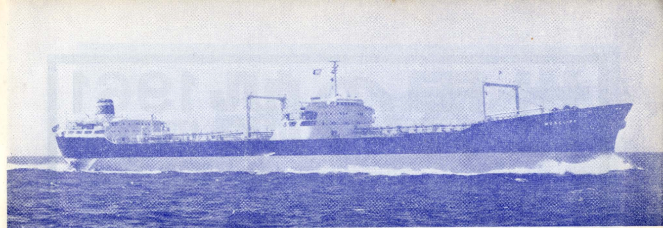
6月13日三菱長崎で竣工したノルウェー向けタンカー“モスクリーフ” Moscliff。50,000 重量トン、航海速力 16.5 ノット
