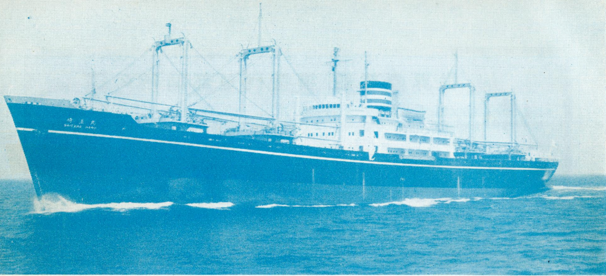
三菱日本重工横浜造船所で去る6月11日竣工した日本郵船の第14次船崎丸。11,560重量トン、最大速力20.8ノット
