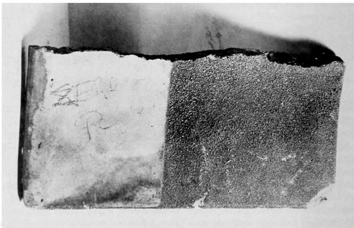
図-7.47 発泡した瓦：瓦の左側部分は重なっていたため遮蔽されていた。（広島における爆心地から0.37マイル）
