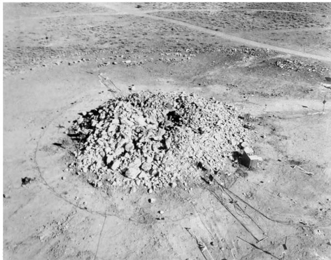
図-6.05 実験S U L K Yでの現象：0.087K Tの90フィート地下核爆発における岩盤が盛上った爆破口
