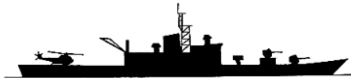
注：X-18（デッキ・ハンガー方式、5インチ砲前部、） （飛行甲板長 大）
